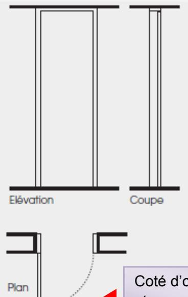
Coté d'ouvrant de la porte et sens d'ouverture et de fermeture
