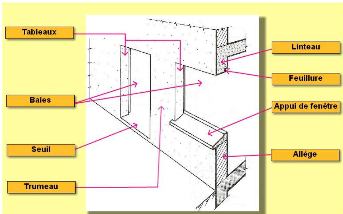
**BAIES** : Les baies sont des **ouvertures** qui ont été réservées dans les murs. Elles permettent le passage des personnes (portes, portes fenêtres ...). Elles assurent un éclairage naturel et la ventilation des pièces.
